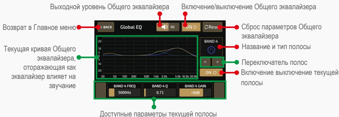
Параметры 4-полосного параметрического эквалайзера с обрезными фильтрами низких/высоких частот и полочными фильтрами низких/высоких частот с индивидуальными переключателями включения/выключения полосы:
