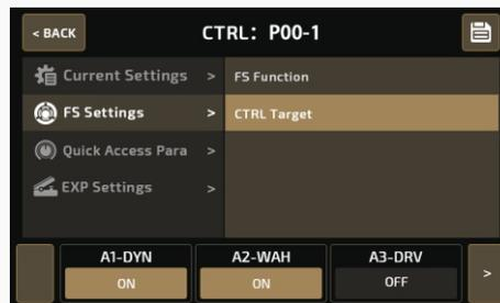
12 слотов эффектов отображаются на панели, с атрибутами «ON» и «OFF» под каждым модулем, это показывает, активирован ли переключатель CTRL для этих слотов или нет:
